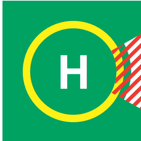
Figura 5-5. Señal de sector de aterrizaje prohibido en la heliplatatorma
